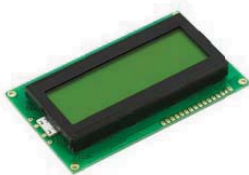
20x4 LCD Display Module
